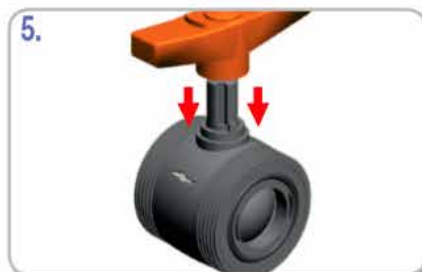
5. Se coloca de nuevo la maneta en posición inicial.
