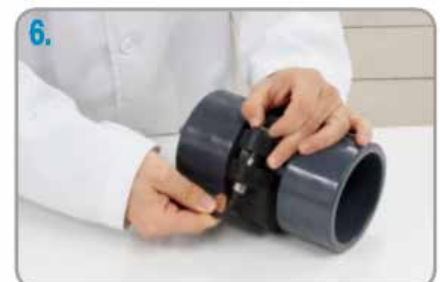
6. Colocar la otra parte de la brida, colocar arandelas, tornillos y proceder a su apriete de modo alternativo y progresivo.
