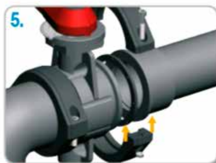
5. Colocar la segunda brida de forma que queden alineadas y apretar los tornillos alternativamente.
