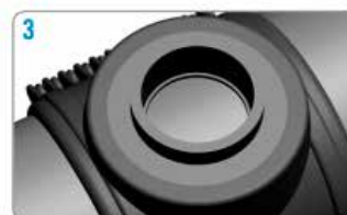
3. Usar el collarín para marcar la posición de la salida.
