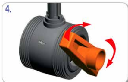
4. Apriete del portateflón hasta el punto deseado.
