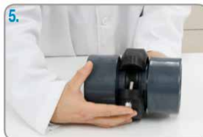
5. Colocar una parte de la brida y presentar la tornillería.
