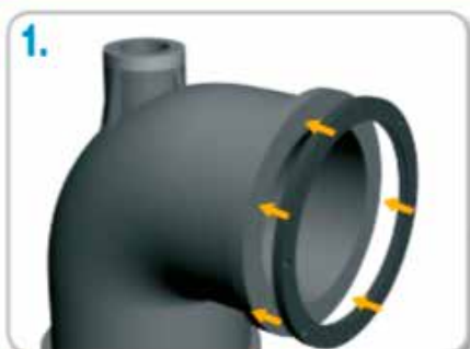
1. Colocar la junta J-BIL en la cara exterior del accesorio.
