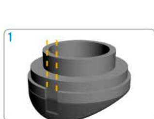
1. Colocar la junta en la boca haciendo coincidir ambas ranuras de montaje.
