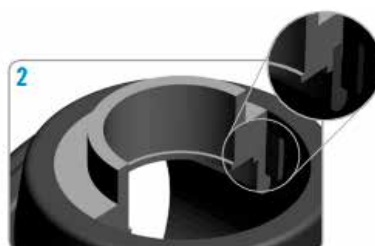
2. Introducir el conjunto boca-junta haciendo coincidir las ranuras en las guías del cuerpo.
