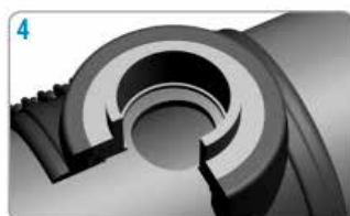
4. Perforar el tubo y colocar centrado el collarín.
