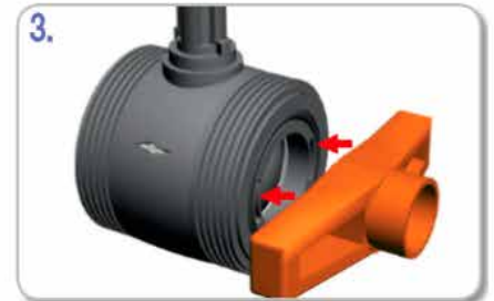
3. A continuación ajustamos la maneta al portateflón, introduciendo la parte dentada de la maneta en las dos muescas.
