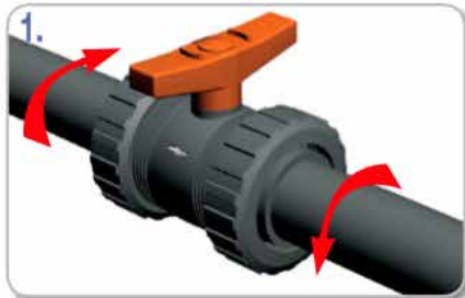
1. Liberar el cuerpo de la válvula de la instalación, aflojando las tuercas en el sentido de las flechas como se muestra en la imagen.
