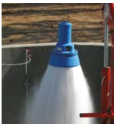
VÁLVULA DE SOBREPRESIÓN DJET EN UN ENSAYO EXPERIMENTAL
