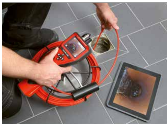
Inspección de drenajes de baños
